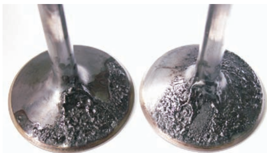
Fot. 4. Zawory dolotowe jako silnikowe elementy testowe (CEC F-05-93)
