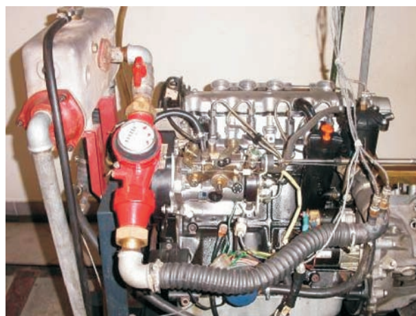
Fot. 7. Stanowisko testowe z silnikiem PSA XUD9 A/L (INiG)
