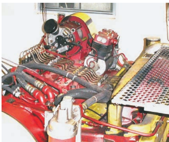
Fot. 9. Widok silnika SWT 11/300/1 z filtrem cząstek stałych na stanowisku badawczym (ITN)
