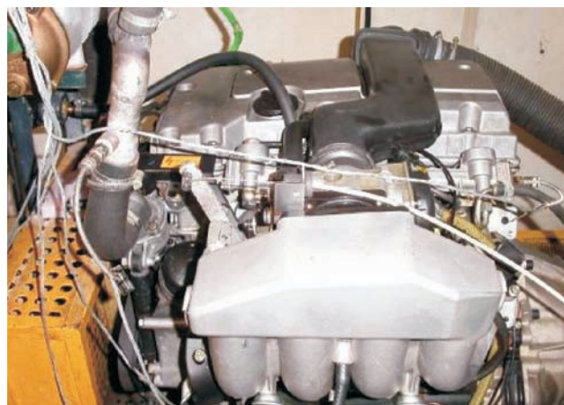
Fot. 5. Stanowisko testowe z silnikiem Mercedes-Benz M111 (INiG)
