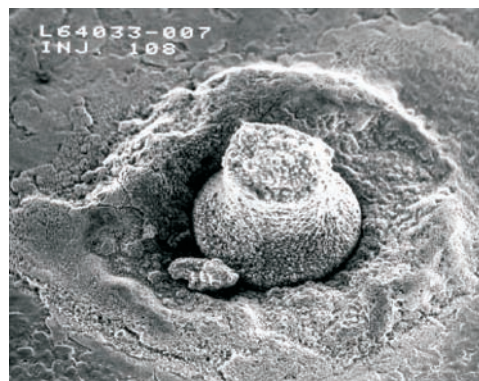
Fot. 8. Osady na rozpylaczach wtryskiwaczy a) rozmieszczenie, b) widok osadów
