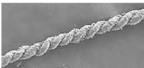
Rys. 6. Splot nanorurek węglowych ( nanorope ) [29]
