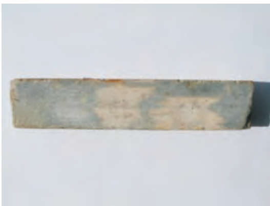
Fot. 1. Kamień żużlowy „A” po 11 latach ekspozycji w 40°C
