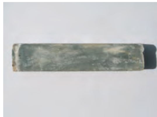
Fot. 2. Kamień żużlowy „B” po 11 latach ekspozycji w 40°C
