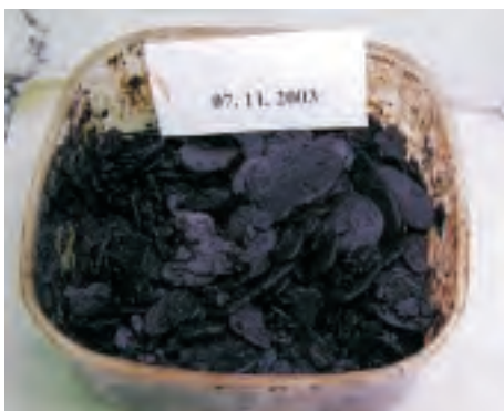
Rys. 2. Wytrączenia organiczne z ropy B, zawierające 60% frakcji asfaltenowej
