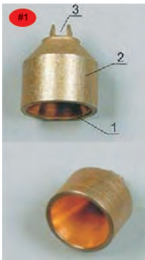
Rys. 4. Ładunek osiowo-kierunkowy ŁOKT-H-Fe-33-150
