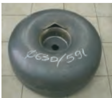
Rys. 8. Zbiornik po próbie rozerwania pod ciśnieniem hydraulicznym
