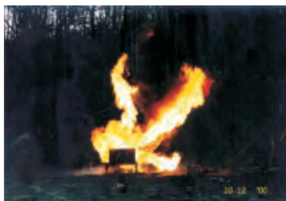
Rys. 10. Próba ogniowa zbiornika przeznaczony do magazynowania LPG
