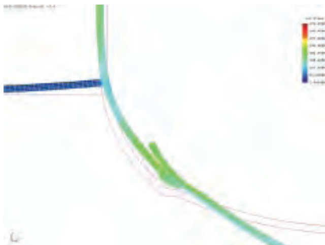
Rys. 11. Przemieszczenia ścianek zbiornika przy ciśnieniu wewnętrznym 2,4 MPa
