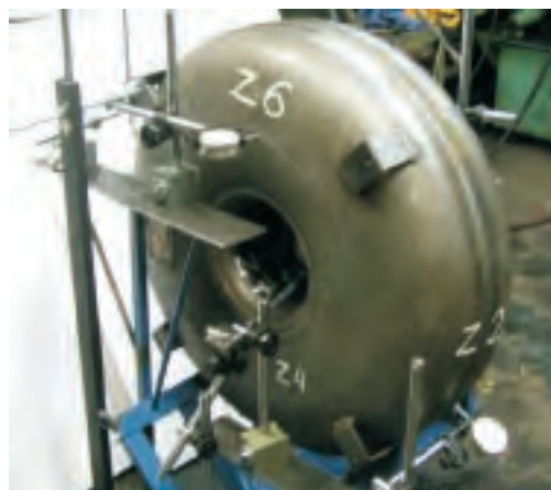
Rys. 12. Pomiary rzeczywistych przemieszczeń ścianek zbiornika w zależności od ciśnienia wewnątrz zbiornika
