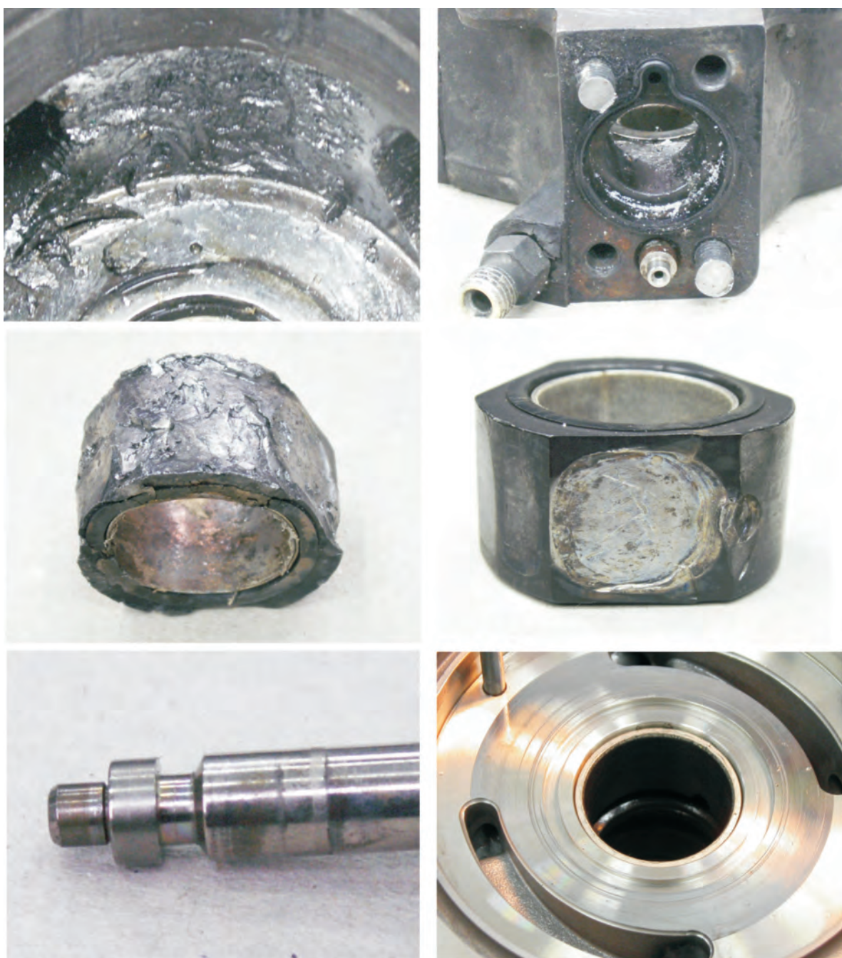
Fot. 1. Widok elementów składowych całkowicie zniszczonej pompy wtryskowej układu Common Rail . Uszkodzenia zostały zapoczątkowane zanieczyszczeniami stałymi w paliwie
