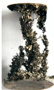
Rys. 17. Odlew otworów robaczkowych po kwasowaniu cieczą o składzie 15% HCl + 0,3% inhibitor korozji + 4% środek żelujący B + 0,5% sieciownik + 0,2% bufor pH + 0,1% stabilizator żelaza, w 90°C
