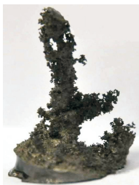
Rys. 11. Odlew otworów robaczkowych po kwasowaniu ciecżą o składzie: 15% HCl + 0,3% inhibitor korozji, w 90°C
