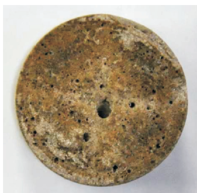
Rys. 14. Powierzchnia czołowa rdzenia nr 5 po kwasowaniu cieczą o składzie 15% HCl + 0,3% inhibitor korozji + 4% środek żelujący C, w 90°C
