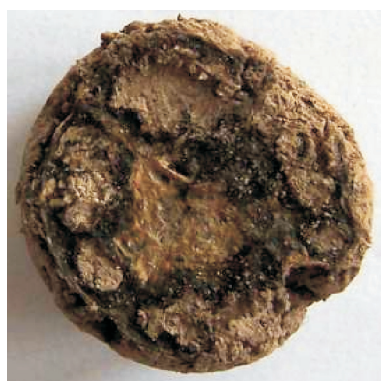
Rys. 16. Powierzchnia czołowa rdzenia nr 6 po kwasowaniu cieczą o składzie 15% HCl + 0,3% inhibitor korozji + 4% środek żelujący B + 0,5% sieciownik + 0,2% bufor pH + 0,1% stabilizator żelaza, w 90°C
