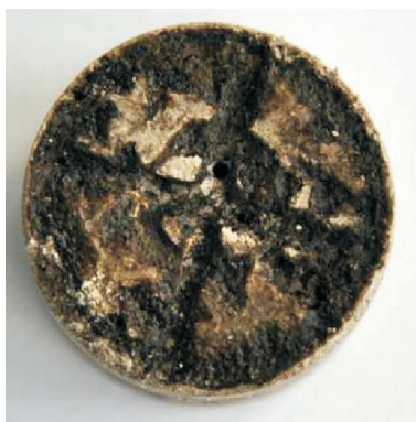
Rys. 12. Powierzchnia czołowa rdzenia nr 4 po kwasowaniu cieczą o składzie 15% HCl + 0,3% inhibitor korozji + 4% środek żelujący B, w 90°C
