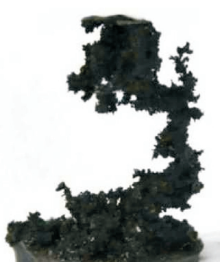
Rys. 15. Odlew otworów robaczkowych po kwasowaniu cieczą o składzie 15% HCl + 0,3% inhibitor korozji + 4% środek żelujący C, w 90°C
