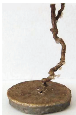
Rys. 9. Odlew otworów robaczkowych po kwasowaniu ciecżą o składzie: 15% HCl + 0,3% inhibitor korozji + 4% środek żelujący A, w 60°C
