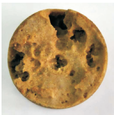
Rys. 10. Powierzchnia czołowa rdzenia nr 3 po kwasowaniu ciecżą o składzie: 15% HCl + 0,3% inhibitor korozji, w 90°C
