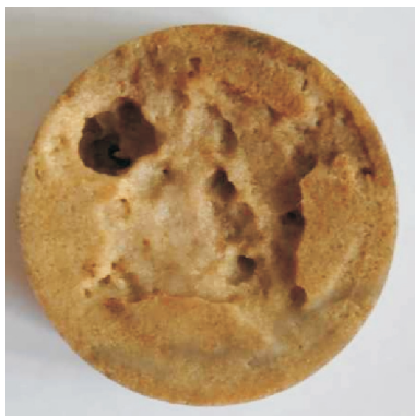
Rys. 6. Powierzchnia czołowa rdzenia nr 1 po kwasowaniu ciecżą o składzie: 15% HCl + 0,3% inhibitor korozji, w 60°C
