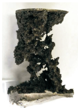
Rys. 13. Odlew otworów robaczkowych po kwasowaniu cieczą o składzie 15% HCl + 0,3% inhibitor korozji + 4% środek żelujący B, w 90°C
