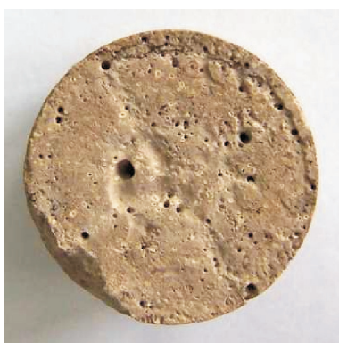
Rys. 8. Powierzchnia czołowa rdzenia nr 2 po kwasowaniu ciecżą o składzie: 15% HCl + 0,3% inhibitor korozji + 4% środek żelujący A, w 60°C
