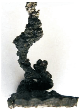
Rys. 7. Odlew otworów robaczkowych po kwasowaniu ciecżą o składzie: 15% HCl + 0,3% inhibitor korozji, w 60°C
