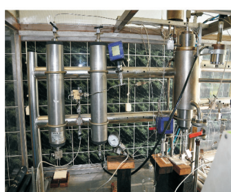
Rys. 2. Stanowisko do symulacji procesów selektywnego kwasowania matrycowego złóż z udziałem azotu, składające się z: zestawu pomp QUIZIX stanowiska ADS, zbiorników z cieczami, komór rdzeniowych oraz gazomierza „RUSKA”
