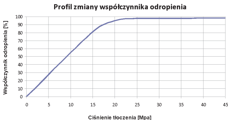
Rys. 8. Profil zmiany współczynnika odropienia złoża w funkcji ciśnienia tłoczenia [5]
