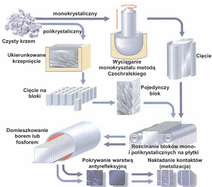
Rys. 1. Wytwarzanie mono- i polikrystalicznych krzemowych ogniw fotowoltaicznych [2]
