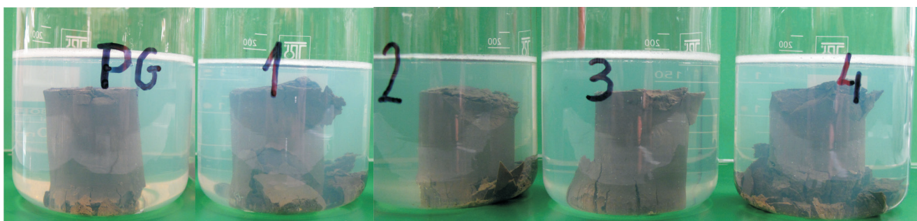
Fot. 10. Próbki łupku mioceńskiego po ok. 1 godzinie w 7-proc. roztworach KCl z dodatkiem 0,8% poliglikolu (PG) oraz w roztworach zawierających 2,09 g: PVAm·HCl (1) PVAm·HCl/GA/50 (2), PVAm·HCl/GA/5 (3) i PVAm·HCl/NMBA (4)
