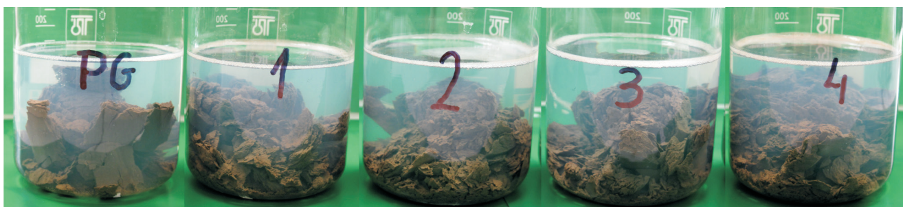
Fot. 11. Próbki łupku mioceńskiego po ok. 3 godzinach w 7-proc. roztworach KCl z dodatkiem 0,8% poliglikolu (PG) oraz w roztworach zawierających 2,09 g: PVAm·HCl (1) PVAm·HCl/GA/50 (2), PVAm·HCl/GA/5 (3) i PVAm·HCl/NMBA (4)
