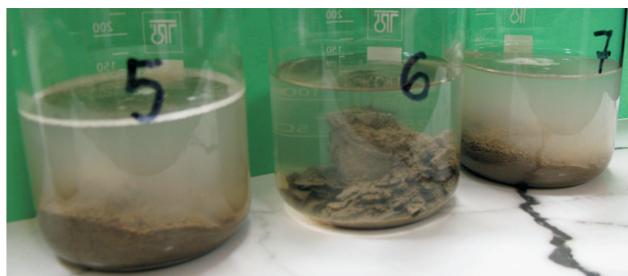
Fot. 5. Próbkę łupki mioceniśkiego po ok. 1 godz. w 0,8-proc. roztworze poliglikolu (5), 7-proc. roztworze KCl (6) oraz wodzie słodkiej (7)
