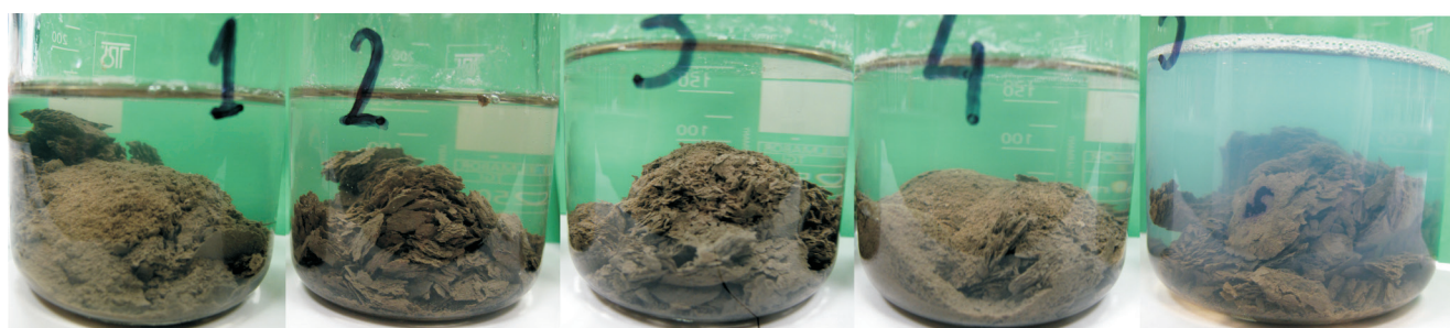
Fot. 8. Próbkę łupku miocenijskiego po ok. 3 godz. w 7-proc. roztworach KCl, zawierających 2,09 g: PVAm·HCl (1) PVAm·HCl/GA/50 (2), PVAm·HCl/GA/5 (3) i PVAm·HCl/NMBA (4) oraz w 0,8-proc. roztworze poliglikolu (5)
