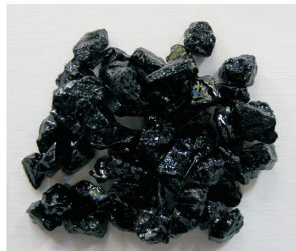
lepiszcze asfaltowe zawierające środek adhezyjny (przyczepność 100%)
