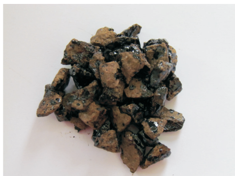
typowe lepiszcze asfaltowe (przyczepność 20%)
