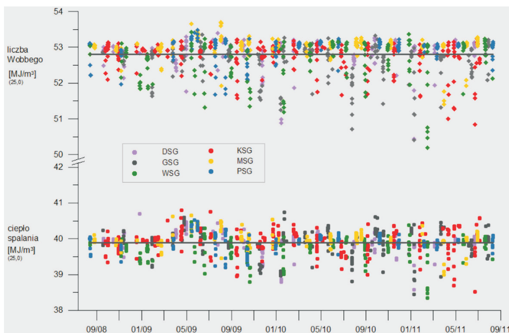
Rys. 3. Wyniki monitoringu ciepła spalania i liczby Wobbego gazu ziemnego „E” w okresie od września 2008 r. do sierpnia 2011 r.
