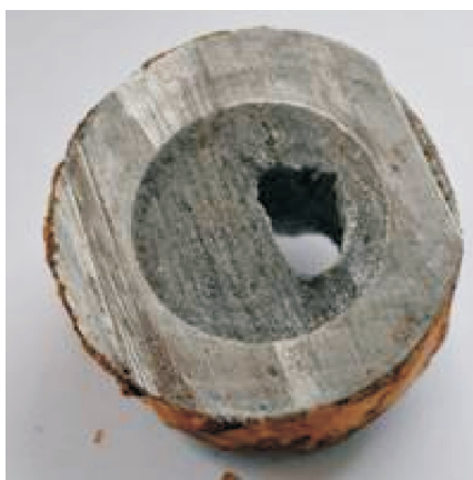
Rys. 1. Przekroje rur zarośniętych osadami polimetalicznymi, zwłaszcza ołowiu (biały kolor to głównie tlenki ołowiu powstałe w wyniku przechowywania próbek na powietrzu)
