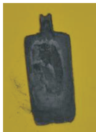
Rys. 8. Elektroda ołowiowa po badaniach prądowych
