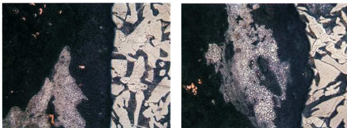
Rys. 4. Mikrostruktura stalowego podłoża i narostu (250X)
