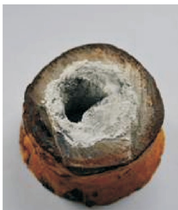
Rys. 1. Przekroje rur zarośniętych osadami polimetalicznymi, zwłaszcza ołowiu (biały kolor to głównie tlenki ołowiu powstałe w wyniku przechowywania próbek na powietrzu)
