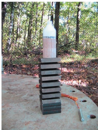
Rys. 5. Układ badawczy z wkładką kumulacyjną – próba druga
