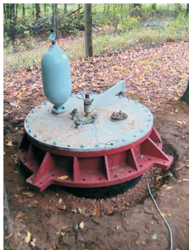
Rys. 1. Widok zbiornika ciśnieniowego do badań paliw
