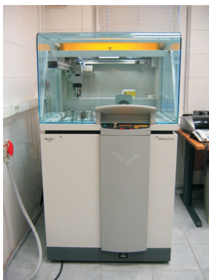
Rys. 1. Spektrometr rentgenowski Axios Petro firmy PANalytical (fot. INiG)
