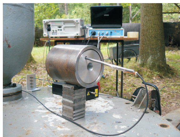
Rys. 4. Ostateczny kształt badanego modelu umieszczonego w komorze balistycznej – fragment perforatora został ułożony wzdłużnie na dziesięciu stalowych płytkach o grubości 10 mm każda. Płytki (test standardowy – stal St3) znajdują się w osi działania strumienia kumulacyjnego, co umożliwia późniejszą ocenę skuteczności działania ładunku
