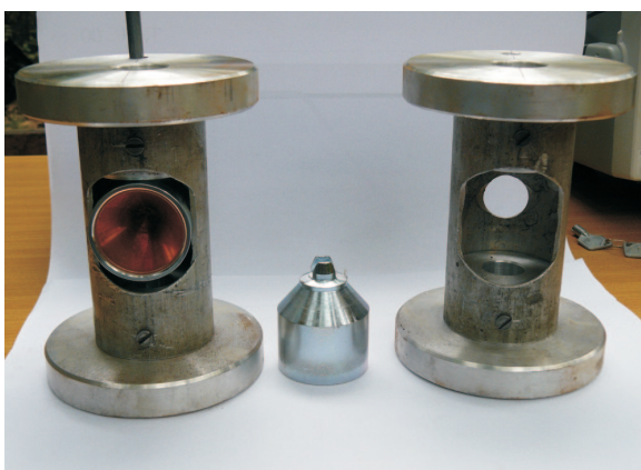
Rys. 3. Wewnętrzna część układu badawczego fragmentu perforatora – ładunek kumulacyjny osadzony na aluminiowej żerdzi nośnej wraz z lontem detonującym; centralizatory o kształcie okrągłym, zapewniające osiowe położenie w rurze perforatora
