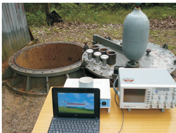
Rys. 1. Otwarta komora balistyczna – przygotowanie stanowiska badawczego i próbek do badań strzałowych
