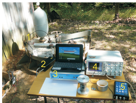
Rys. 2. Zbiornik balistyczny z autonomicznym rejestratorem ciśnienia i systemem generującym impulsy laserowe
