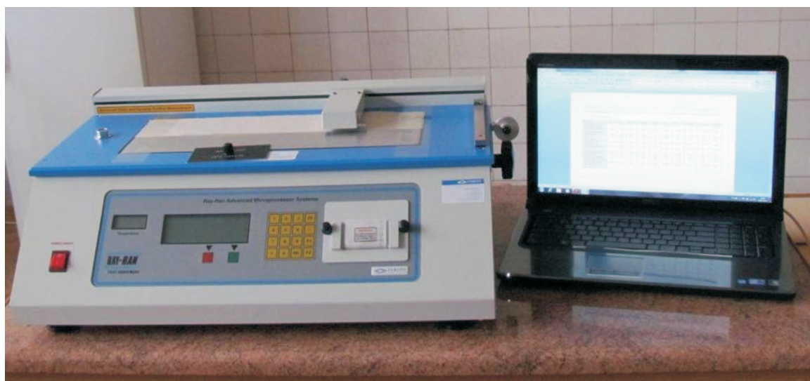
Rys. 7. Aparat cyfrowy Ray-Ran Polytest do oznaczania współczynnika tarcia
