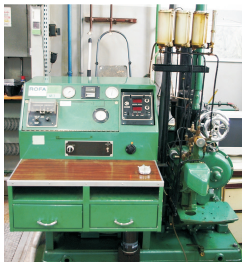
Fot. 1. Stanowisko silnikowe Dresser Waukesha CFR (USA) do oznaczania liczby cetanowej (fot. INiG Kraków)
