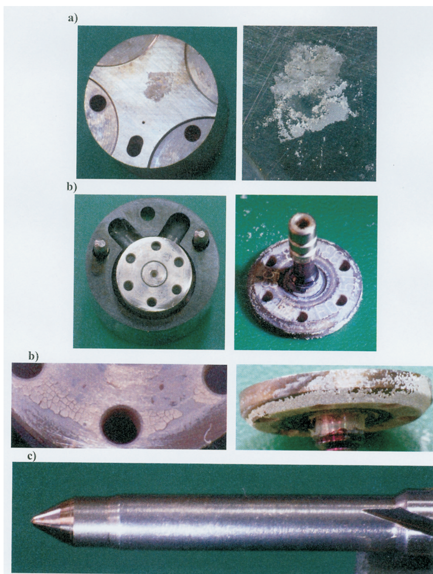
Rys. 2. Osady (typ I) na wewnętrznych elementach wtryskiwaczy układu HPCR a) korpus komory sterującej przepływem paliwa, b) korpus komory i tłoczek sterującego zaworu elektromagnetycznego, c) iglica rozpylacza
