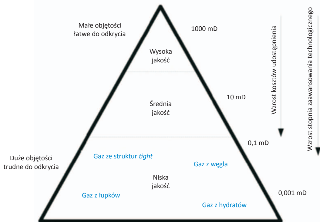
Rys. 1. Schematyczny podział poszczególnych złóż gazu ziemnego w zależności od wartości przepuszczalności skały zbiornikowej [1, 3]
