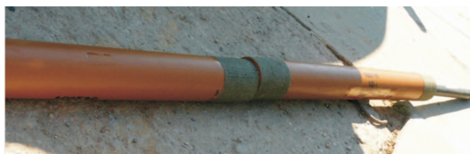
Rys. 1. Widok prochowego generatora ciśnienia wyprodukowanego w INiG przygotowanego do zapuszczenia do otworu wiertniczego
