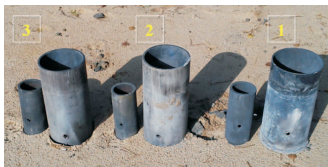
Rys. 12. Zestawienie poprawnie perforowanych rur okładzinowych i korpusów perfogeneratora
