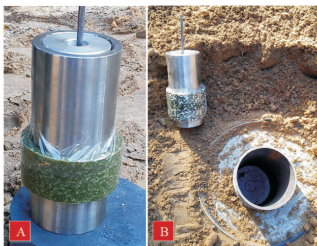
Rys. 11. Widok A przedstawia drugi model strzałowy – na korpus perforatora nałożono propelant na bazie modyfikowanego paliwa Szmaragd® o masie ~222 g. W widoku B atrapa fragmentu odwiertu oraz przygotowany model do próby trzeciej (propelant modyfikowany o łącznej wysokości pierścienia 80 mm i wadze ~288 g)
