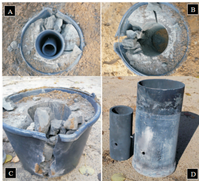
Rys. 10. Rezultaty próby pierwszej: A – model i rura okładzinowa, B – widok spękań betonu, C – przewaga spękań/szczelin w kierunku działania ładunku osiowego, D – otwory perforacyjne w modelu i rurze okładzinowej
