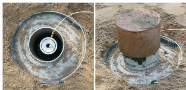
Rys. 9. Atrapa odcinka otworu wiertniczego i umieszczony w niej pierwszy model strzałowy
