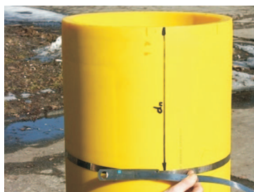
Fot. 1. Sposób pomiaru średnicy zewnętrznej rury PE
