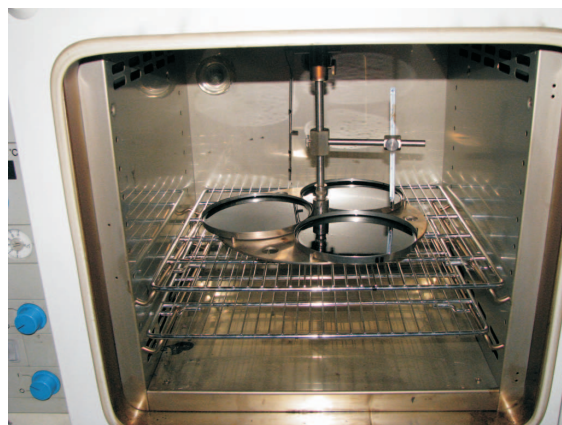
Fot. 6. Aparat do starzenia metodą TFOT (fot. E. Trzaska; INiG Kraków)
