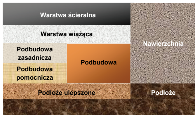
Rys. 2. Schemat konstrukcji nawierzchni drogowej
