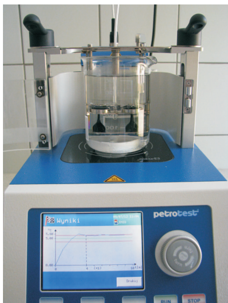
Fot. 2. Pomiar temperatury mięknięcia, metoda Pierścieni i Kula (fot. E. Trzaska; INiG Kraków)
