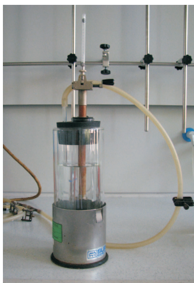
Fot. 3. Aparat manualny do pomiaru temperatury łamliwości, metoda Fraassa (fot. E. Trzaska; INiG Kraków)
