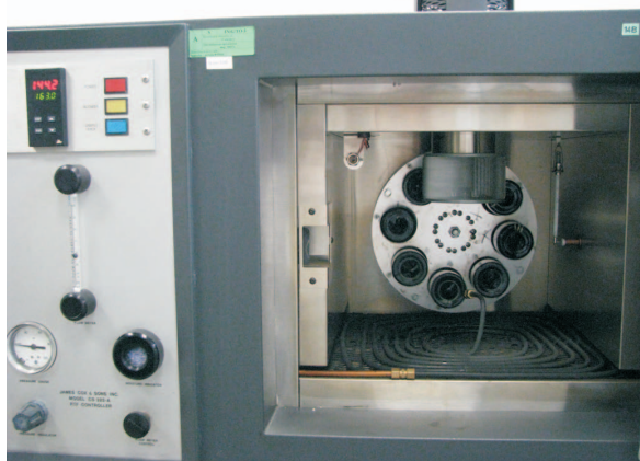
Fot. 5. Aparat do starzenia metodą RTFOT (fot. E. Trzaska; INiG Kraków)
