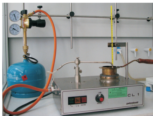
Fot. 4. Aparat do pomiaru temperatury zapłonu metodą Clevelanda (fot. E. Trzaska; INiG Kraków)
