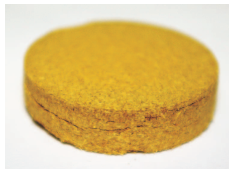
Rys. 7. Pastylka biomasy, która uległa rozwarstwieniu na skutek jej suszenia
