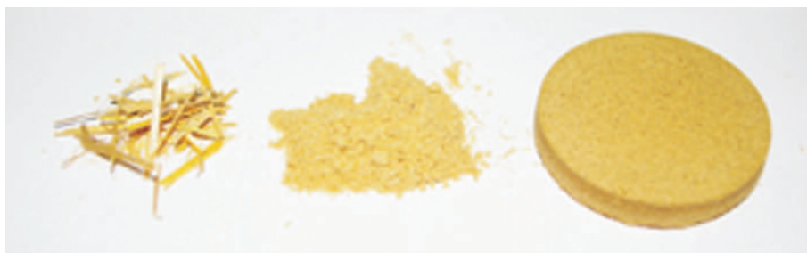
Rys. 1. Próbką przed zmieleniem, po zmieleniu oraz po sprasowaniu
