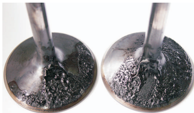
Rys. 1. Osady na zaworach dolotowych silnika Mercedes M102E [INiG – PIB]
