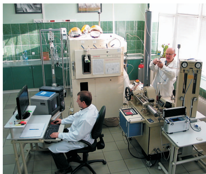
Rys. 5. Stanowisko badawcze do modelowania procesów wypierania [10]
