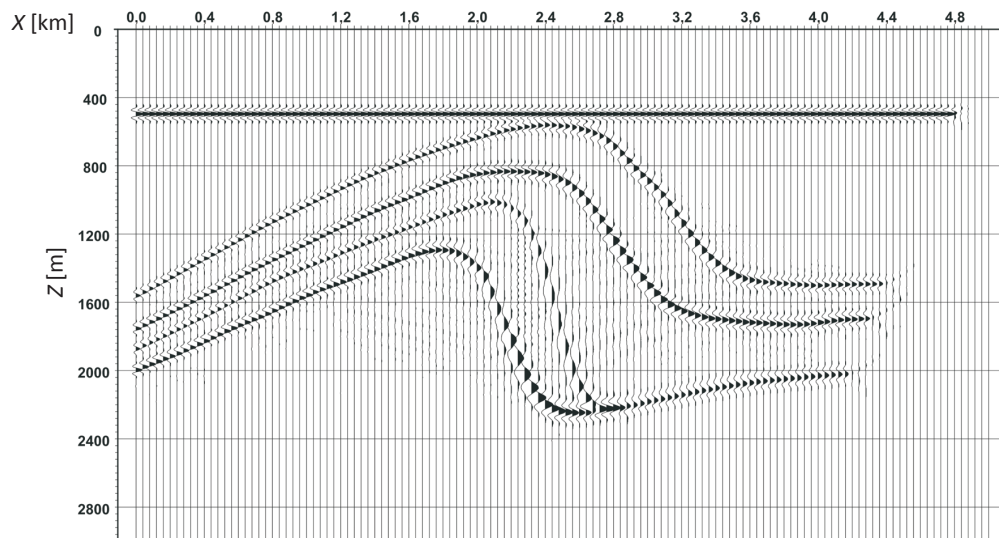
Rys. 6. Migracja zero-offsetowa dla modelu TTI, \theta = -60^\circ sekcji czasowej TTI, \theta = 60^\circ z rysunku 2
