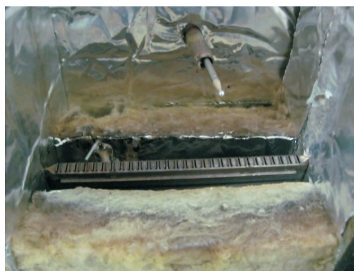
Rys. 4. Wnętrze komory spalania
