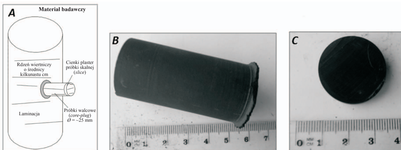
Rys. 1. A – orientacja próbek w stosunku do rdzenia wiertniczego oraz laminacji; B – przykład analizowanej próbki ( core plug ); C – slice wycięty z próbki
