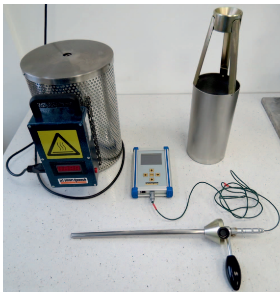
Rys. 1. Aparat do oznaczania zdolności chłodzących olejów hartowniczych metodą pomiaru krzywych chłodzenia
