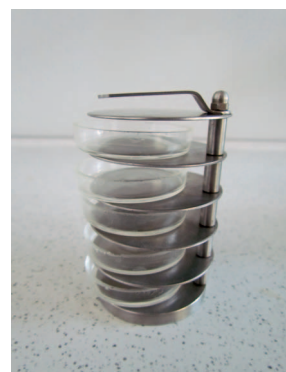
Rys. 2. Zestaw do oznaczania odporności na utlenianie według PN-C-04143:1956 (fot. INiG – PIB)
