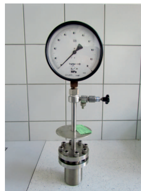
Rys. 1. Aparat do oznaczania odporności na utlenianie według PN-C-04143:1956 (fot. INiG – PIB)
