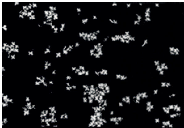
Fot. 2. Mikrofotografia kryształków parafiny (białe drobinki) pod mikroskopem polaryzacyjnym [21]
