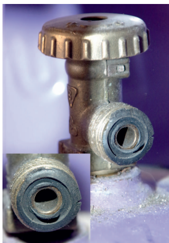
Fot. 3. Zawór butli 11 kg ze zużytą uszczelką (fot. T. Minor)
