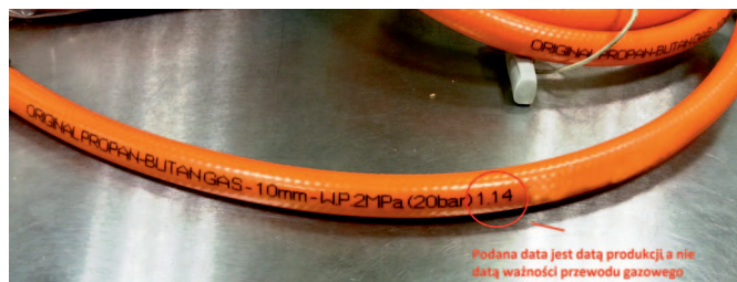
Fot. 2. Znakowanie przewodu gazowego butli propan-butan (fot. T. Minor)
