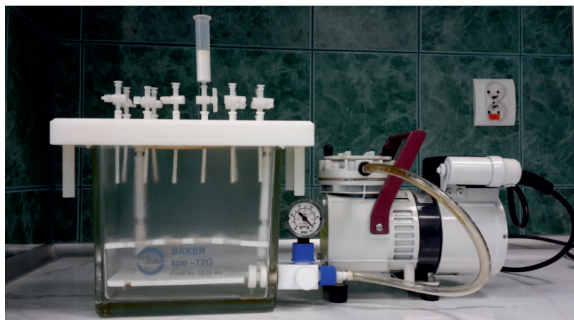
Fot. 1. System próżniowy BAKER SPE do przygotowania próbek z wykorzystaniem kolumniek SPE
