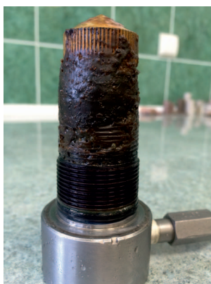
Fot. 1. Widok wychwyconego osadu na powierzchni filtra dla próbki ropy z Buszewa
