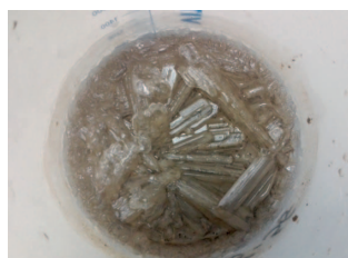
Rys. 3. Widok próbek poddawanych procesowi rozdrabniania za pomocą soli glauberskiej
