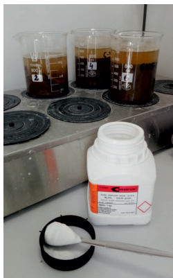
Rys. 3. Widok próbek poddawanych procesowi rozdrabniania za pomocą soli glauberskiej
