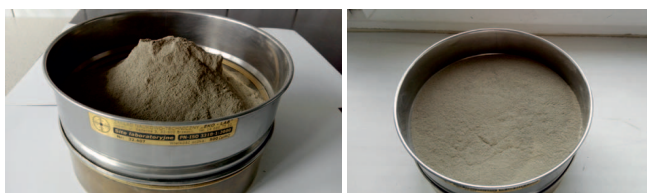
Rys. 1. Widok próbki rozkruszanej młotkiem i przesiewanej przez sito 0,5 mm
