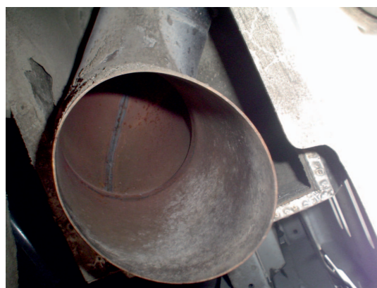
Fot. 4. Rura wydechowa autobusu zasilanego CNG
