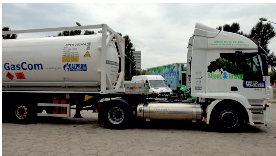
Fot. 1. Ciągnik siodłowy mogący tankować CNG lub LNG wraz z cysterną LNG
