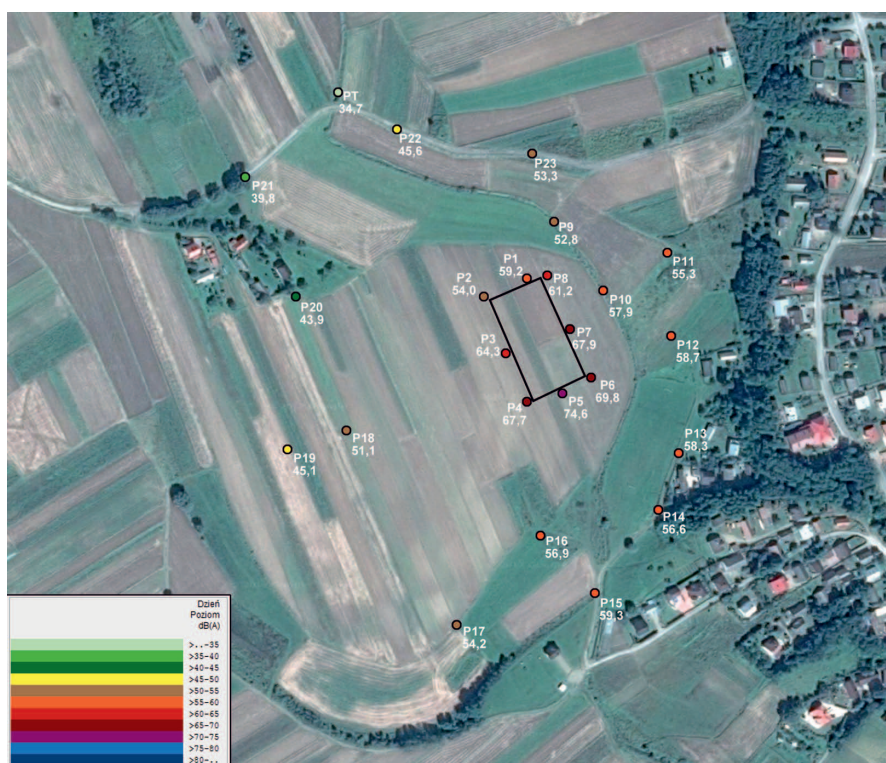
Rys. 3. Lokalizacja punktów pomiarowych wokół wiertni Parkosz-2K wraz ze zmierzonym poziomem dźwięku – etap rurowania
