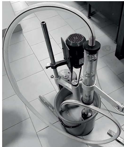
Fot. 5. Symulator przepływu cieczy wiertniczych – widok ogólny
