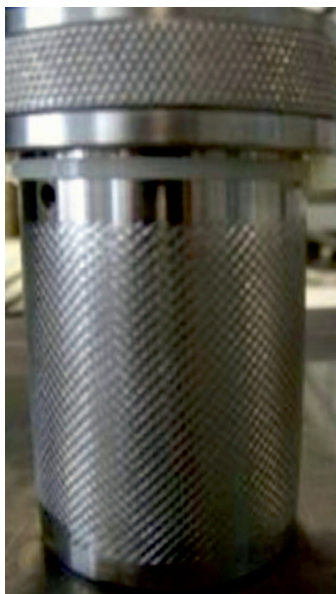
Fot. 3. Rotor wiskozymetru obrotowego poddany modyfikacji poprzez nacinanie
