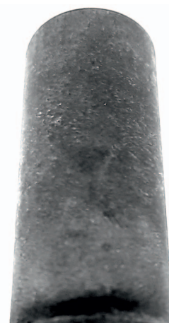
Fot. 7. Próbką rdzenia stalowego odwzorowującej powierzchnię rury okładzinowej
