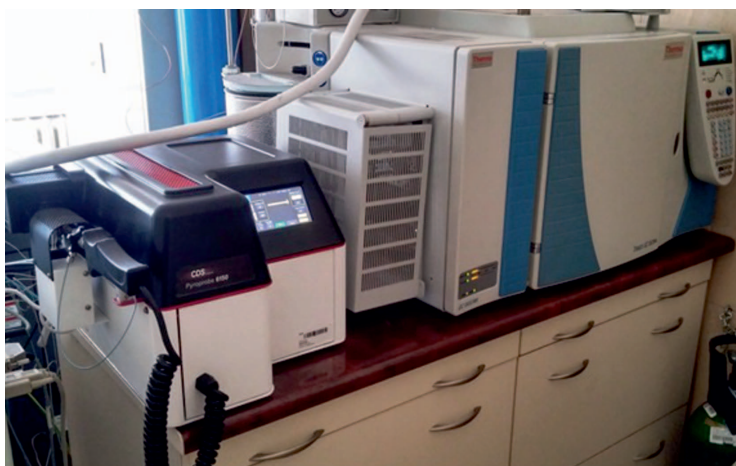
Rys. 2. Pirolizer Pyroprobe 6150 połączony z chromatografem gazowym Trace GC Ultra
