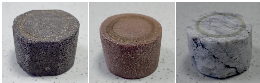
Fot. 1. Próbki skał: anhydryt, piaskowiec, dolomit Photo 1. Rock samples: anhydrite, sandstone, dolomite
