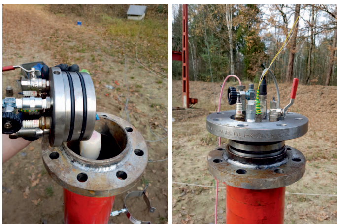
Rys. 3. Widok układu przed i po zamknięciu komory spalania Fig. 3. A view of the testing setup prior to and after closure of the combustion chamber
