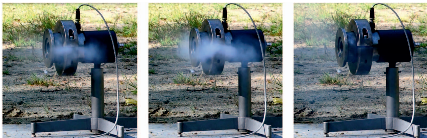
Rys. 2. Sekwencja zdjęć przedstawiająca jedną z prób szczelinowania gazowego węgla z wykorzystaniem propelantów
