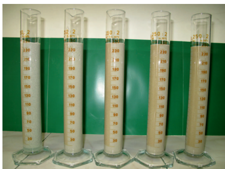
Rys. 17. Frakcjonowanie mikrosfer z dodatkiem przeciwsedymentacyjnym BTE na początku pomiaru
