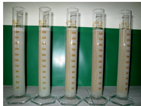
Rys. 24. Frakcjonowanie mikrosfer z dodatkiem przeciwosiedymtacyjnym Nano-SiO 2 na początku pomiaru
