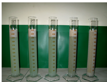
Rys. 10. Frakcjonowanie mikrosfer z dodatkiem przeciwosedymentacyjnym XD po czasie 2,5 minut
