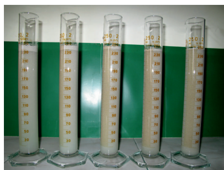
Rys. 13. Frakcjonowanie mikrosfer z dodatkiem przeciwosiedimentacyjnym GS na początku pomiaru
