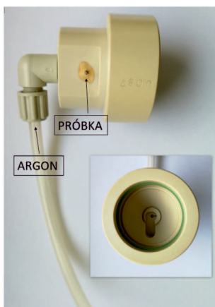
Rys. 2. Rozpylacz krzyżowy, widok z boku i przodu
