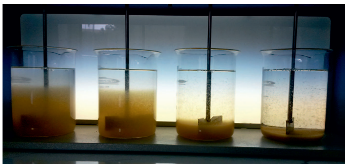
Rys. 2. Woda złożowa w czasie badań laboratoryjnych środka Flokor 1ASW (odczyn skorygowany do pH = 7,0, dawki 10, 20, 30, 40 µl/dm 3 ) po 30 min sedymentacji
