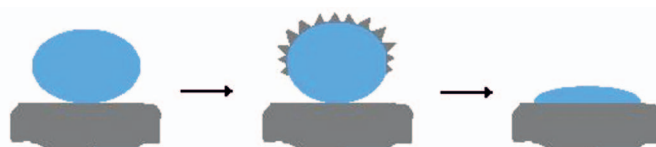
Rys. 3. Schemat działania sterycznego środków uplastyczniających
