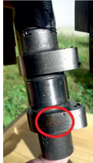
Rys. 5. Przykładowe elementy pokryte środkiem do ochrony czasowej Fig. 5. Examples of elements covered with a temporary protection agent
