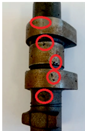
Rys. 7. Wygląd elementów na przykładowych dwóch stanowiskach po 120 dniach ekspozycji Fig. 7. The appearance of elements in the example two stands after 120 days of exposure
