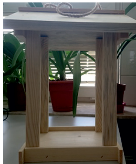
Rys. 1. Stanowisko do badań eksploatacyjnych oleju ochronnego w warunkach polowych
